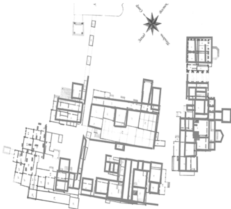
Рис. 1 Общий план погребенного фундамента дворца Царя Алексея Михайловича (ГМЗ «Коломенское»), по данным опережающих геофизических исследований.
